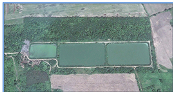
Lagunas Anaeróbica + Facultativa + Maduración en serie.
