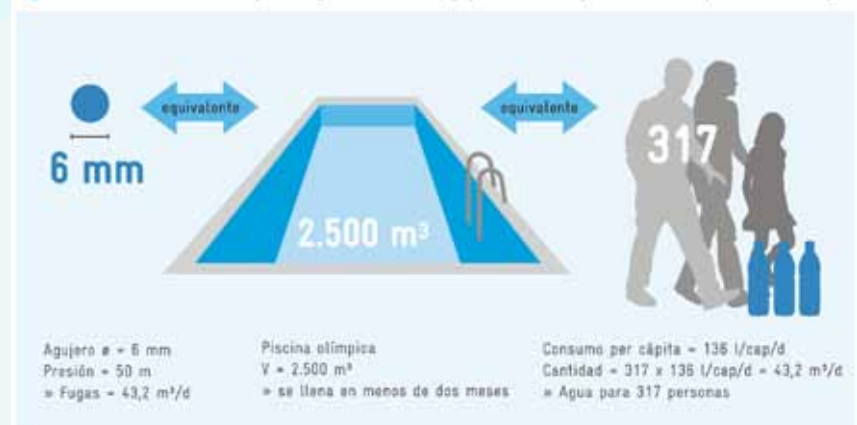
Figura 2 La tasa del flujo de fuga de un único agujero de 6 mm y el volumen equivalente de agua
